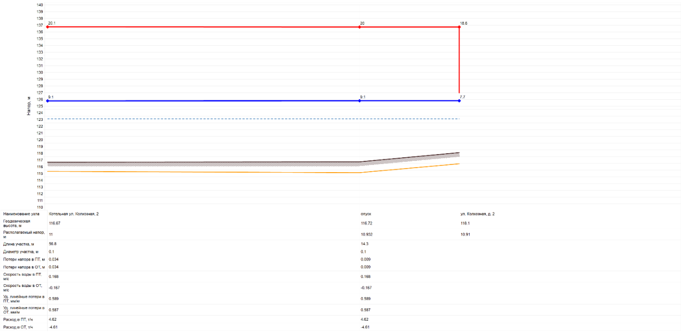
Рисунок 2.28 – Пьезометрический график участка тепловой сети от котельной ул. Колхозная, 2
